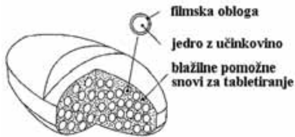
Slika 1: Shematski prikaz večnotne farmacevtske oblike – tablete stisnjene iz obloženih pelet (4).
