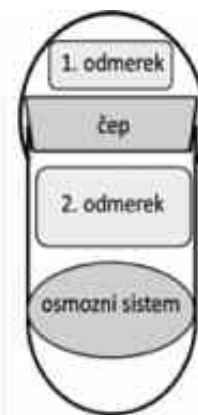
Slika 4: Zgradba kapsule, ki omogoča dvopulzno sproščanje učinkovine (prirejeno po 43).
